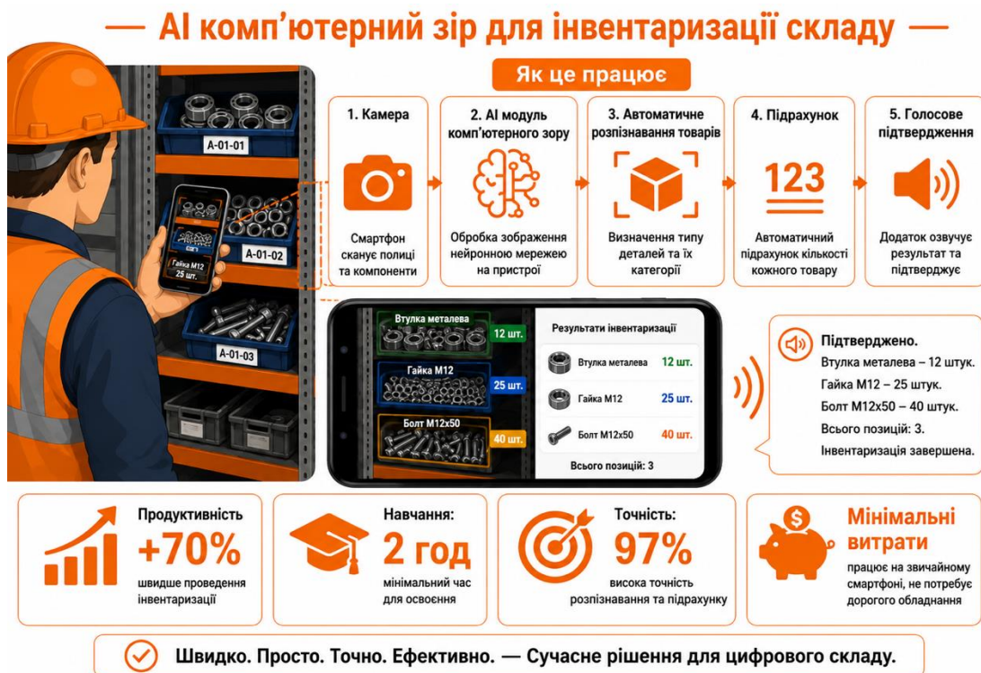
Рис. 3.4. Принцип роботи мобільного додатка з модулем ШІ на базі комп'ютерного зору Джерело: сформовано автором на основі [40; 42]
