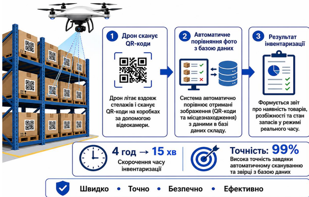
Рис. 3.2. Схема функціонування системи БПЛА з відеокамерами для ШІ-інвентаризації Джерело: сформовано автором на основі [40; 42]
